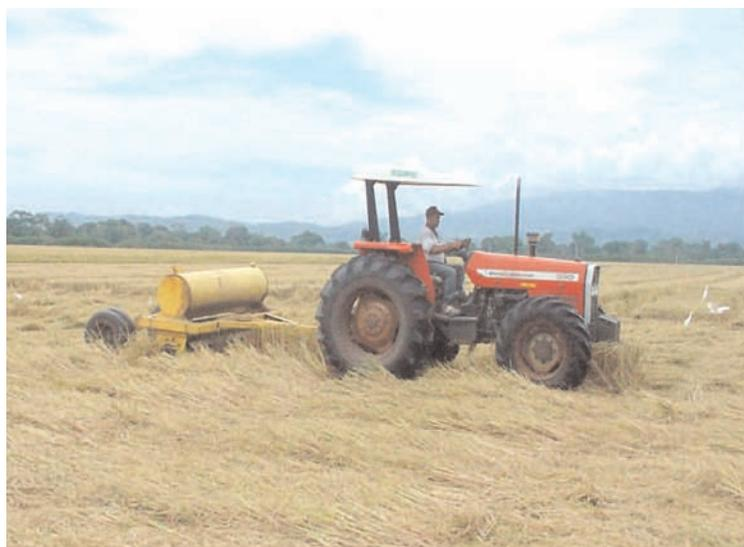
Figura 13. Uso de un rolo compactador en retoño
