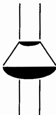
Figura 1. Dispositivo tipo embudo invertido para impedir el acceso de ratas a los almacenes.
