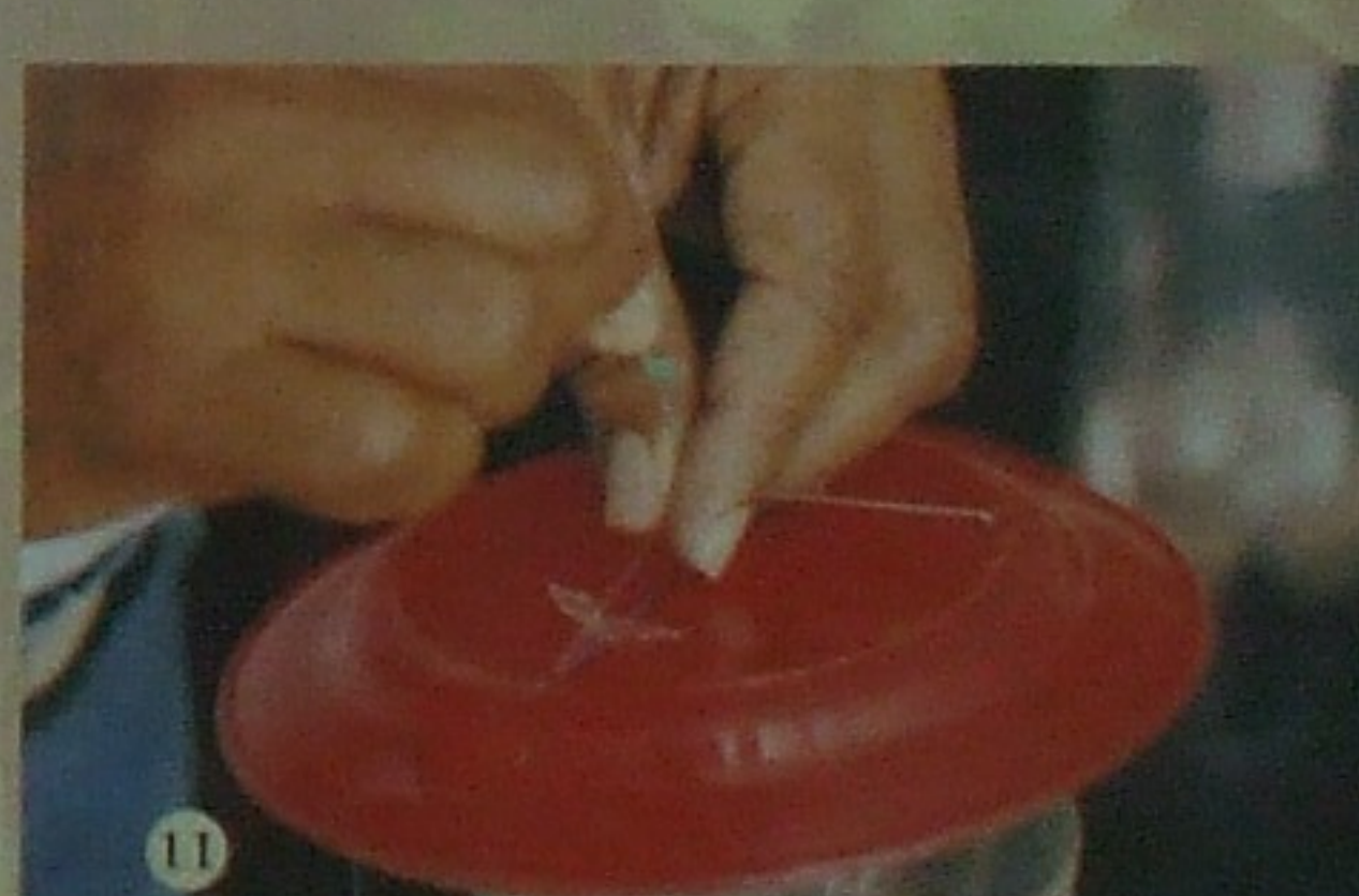
Ensamblaje: Se toma el recipiente recolector y se introduce de adentro hacia fuera las cuerdas de hilo por los puntos de sostén. Después se toma el embudo de captura y se coloca con la apertura menor hacia la base de la botella, pasando uno de las cuerdas de hilo por la perforación. Luego se realiza un nudo sencillo a cada hilo en la marca ya realizada.
