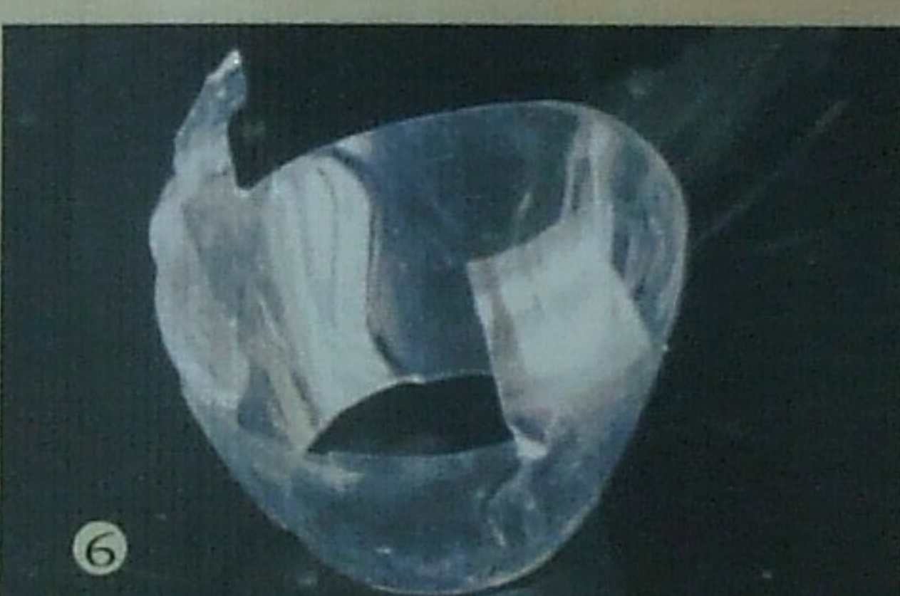
Se corta y dobla hacia arriba las dos pestañas. En la base de estas, se realiza un pequeño corte de 0.5 cm y luego se doblan hacia fuera. La parte superior de la botella se corta a 2 cm por debajo de la rosca de la tapa. Luego se realizan dos perforaciones a 1 cm del corte a ambos lados guiándose por las líneas de unión de la botella. Estas perforaciones se utilizan para colocar el difusor.
