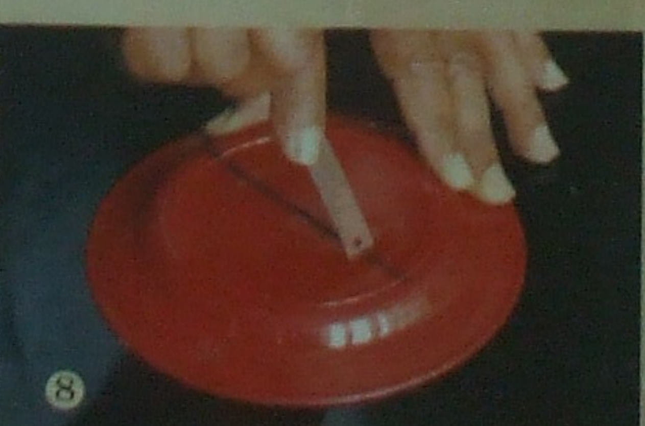
Luego se procede a perforar el plato y se marcan dos líneas paralelas entre sí, cada una a 3 cm de distancia del centro del plato. En cada línea se hace una ranura de aproximadamente 1.2 cm de largo.
