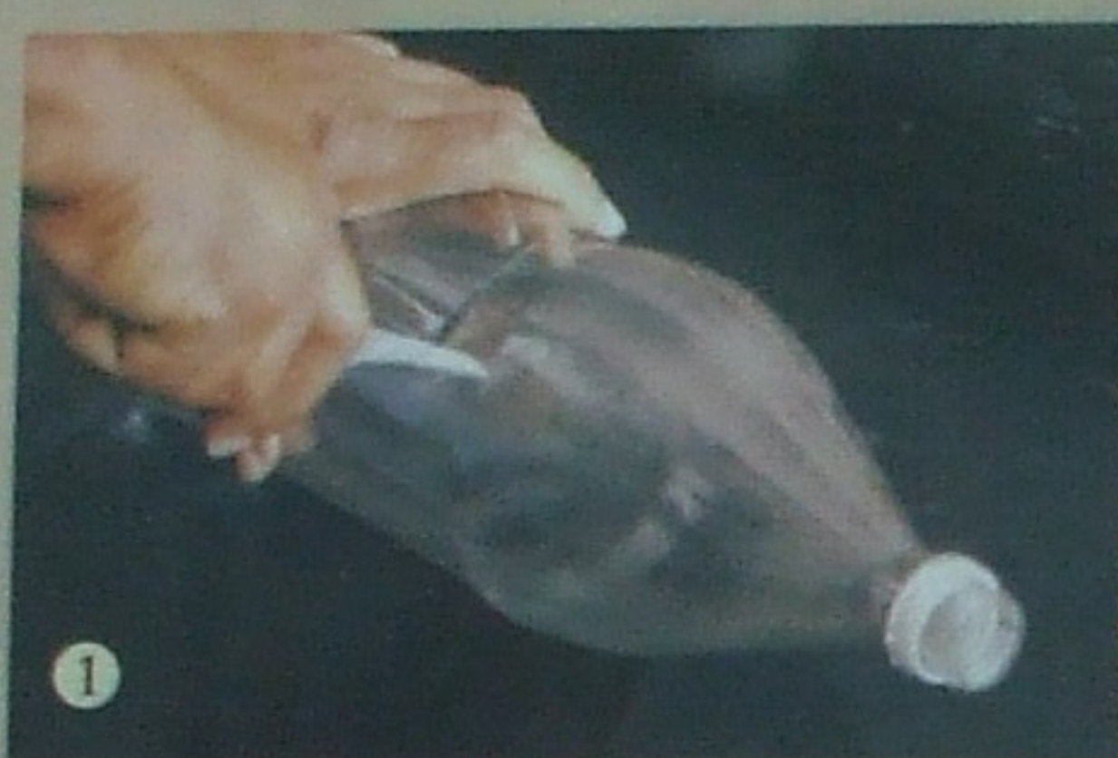
Las botellas plásticas se seleccionan sin abolladuras ni roturas y se limpian cuidadosamente. La altura de la botella de doble litro se estandariza en 19 cm desde la base hacia arriba. En este punto se marca y corta.
